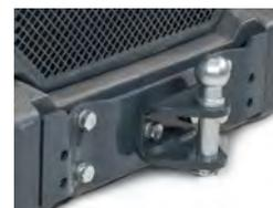
L'attelage de remorque peut être monté soit directement sur le pare-choc arrière soit sur le poids arrière supplémentaire.
