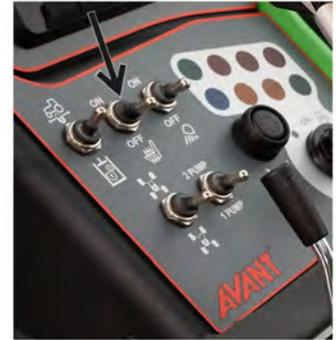
**Pour régler le siège à suspension pneumatique :**
