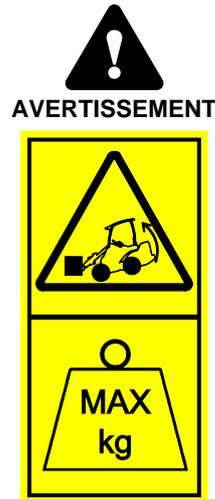
**Risque de basculement - Suivez les instructions de sécurité.** La capacité de levage du chargeur est limitée par la possibilité de basculement autour de l'axe avant.
