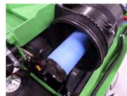
Remplacez l'élément interne de filtre à air si vous observez de la saleté ou des dommages dessus, ou si sa couleur a changé du bleu foncé d'origine. Par ailleurs, remplacez les deux éléments de filtre à air si le principal filtre à air s'est endommagé.
