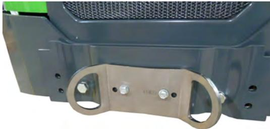
Attachez l'oeillet d'arrimage réf. A418623 installé sur le côté du châssis arrière
