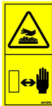
**Risque de brûlures - Permettez que le chargeur refroidisse avant d'ouvrir les couvercles.**
