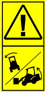
L'irrégularité du sol peut provoquer le retournement du chargeur - **Risque de blessure grave ou de mort.** La stabilité et la capacité de manipulation des charges du chargeur sont considérablement réduites sur des terrains inclinés et la capacité de levage maximale ne peut être atteinte que sur un sol ferme et horizontal. Sur des terrains à inclinaison horizontale, la charge doit être maintenue près du sol et ne doit jamais être levée en hauteur.
