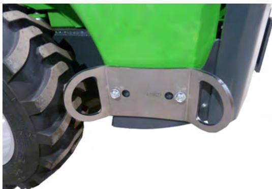
Deux oeillets sont nécessaires pour l'installation sur les côtés.
