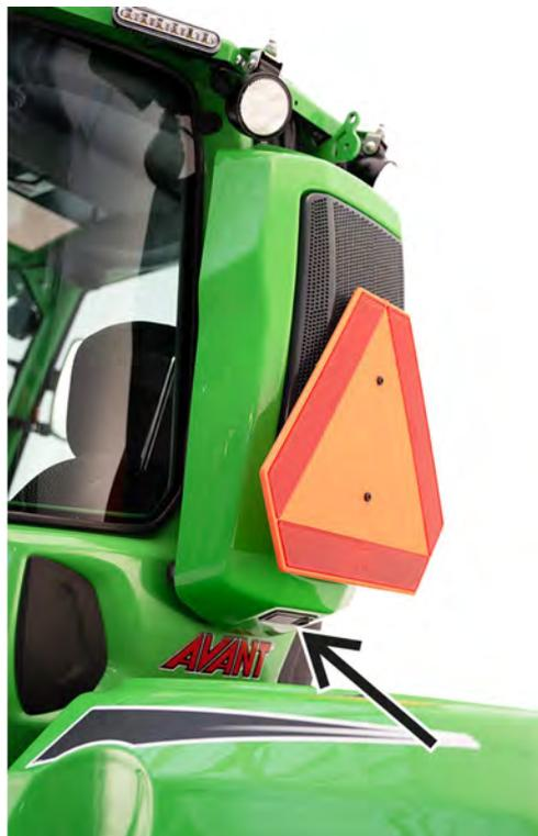
Pour retirer complètement le couvercle, débranchez le câble électrique dans le coin supérieur gauche.
