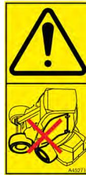
**Risque de bris de verre - Ne conduisez pas avec une porte de cabine ouverte.** La porte peut se briser au contact avec les roues. Par ailleurs, tournez le châssis articulé en position droite avant d'ouvrir la porte.
