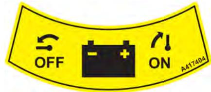
Désactivez toujours le courant principal avant de laisser le chargeur sans surveillance, et avant de procéder à sa maintenance ou à des inspections. Retirez la clé pour éviter une utilisation non autorisée.
