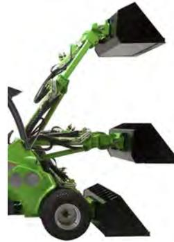
Le système de parallélogramme du bras de levage maintient automatiquement la position de l'accessoire par rapport au sol, indépendamment de la position du bras de levage.
