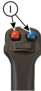
Appuyez et maintenez enfoncé n'importe quel bouton pour commander le sens du flux des hydrauliques extérieures.
