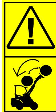
**Risque de blessure grave ou de mort dû à la chute des objets.** N'inclinez jamais l'accessoire pour le remettre en place lorsqu'il est élevé en hauteur. Manœuvrez uniquement les machines équipées de structure ROPS et FOPS. Protégez les charges sur les accessoires si elles peuvent tomber. Utilisez le type d'accessoire approprié pour différentes charges et suivez les manuels d'utilisation des accessoires.
