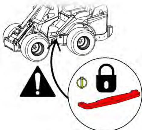
Fermez toujours le verrou de châssis avant de transporter ou de lever le chargeur. Rappelez-vous également de retirer le verrou de châssis et de testez le braquage du chargeur après le transport.
