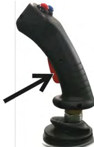
La valve anti-patinage est actionnée en appuyant continuellement sur l'interrupteur se trouvant sur le joystick.
