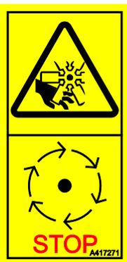
**Risque de contact avec des pièces mobiles - Arrêtez toujours le moteur avant d'accéder au compartiment moteur.** Le ventilateur de refroidissement du moteur, la courroie d'alternateur, et les poulies à courroie se déplaceront à une vitesse élevée lorsque le moteur est en marche. N'ouvrez jamais le couvercle de moteur lorsque le moteur est en marche.
