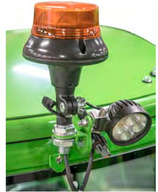
Traitez le gyrophare avec soin. Le gyrophare est scellé et ses composants internes ne peuvent pas être remplacés ou réparés par l'utilisateur.
