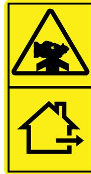
**Risque d'asphyxie - Assurez la ventilation.** L'échappement du moteur contient, entre autres polluants, du monoxyde de carbone (CO), un gaz toxique que vous ne pouvez ni voir ou sentir. L'utilisation d'un chargeur dans un espace clos ou dans des zones mal ventilées provoquera une perte de conscience ou votre décès après quelques minutes.
