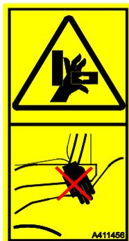
**Points de pincement - Évitez de vous faire écraser les mains ou les pieds entre les châssis avant et arrière du chargeur ou entre le chargeur et les murs - Gardez toutes les parties du corps à l'intérieur du cadre de sécurité.**
