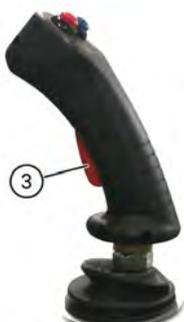
Un interrupteur en option sur le côté arrière du joystick (3) est l'interrupteur de commande de la valve anti-patinage.
