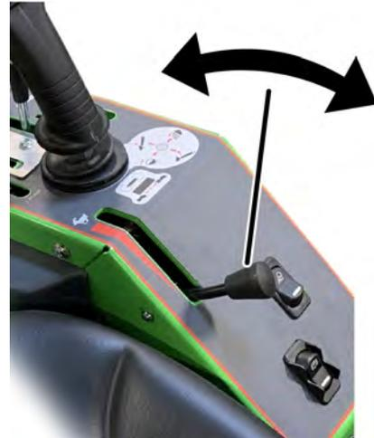
Le régime du moteur affecte la vitesse de conduite et peut être utilisé pour contrôler la vitesse de conduite en association avec les pédales de marche.
