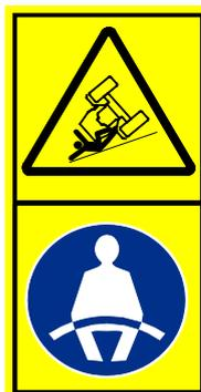
**Portez toujours la ceinture de sécurité lorsque vous utilisez le chargeur. La ceinture de sécurité vous maintiendra à l'intérieur de la zone ROPS en cas de basculement du chargeur.** Si vous ne portez pas la ceinture de sécurité, vous risquez d'être écrasé entre le ROPS et le sol en cas de basculement du chargeur. Voir plus d'informations concernant les réglages de la ceinture et la ceinture de sécurité à la page 78.
