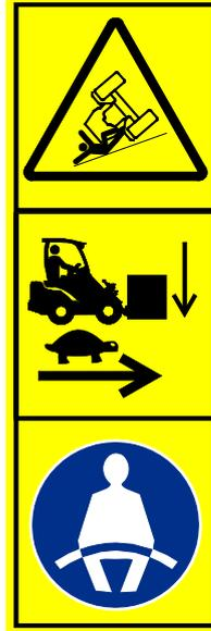
**Risque de basculement sur un sol irrégulier - Conduisez lentement sur des surfaces inclinées. Gardez toujours les charges près du sol. Maintenez la ceinture de sécurité attachée pour rester dans la structure de protection contre la chute.** Manipulez toujours les charges lourdes uniquement sur un sol plat et solide, tout en conduisant lentement le chargeur.
