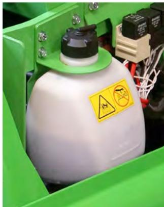
Le système de refroidissement du moteur utilise un réservoir sous pression. Le niveau de liquide de refroidissement doit être supérieur au marquage minimum indiqué sur le réservoir, et au moins de 3 cm en-dessous du bouchon de remplissage.
