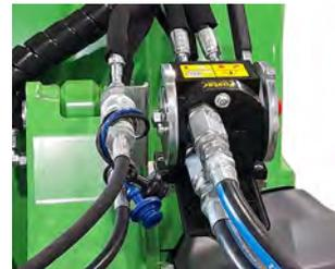
S'ils sont fixés à l'arrière, les raccords rapides sont placés à l'arrière sur la gauche.
