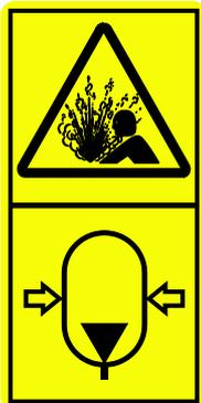
**Risque d'explosion de l'huile hydraulique - Isolez l'accumulateur hydraulique avant l'entretien** Si le chargeur est équipé de l'option de suspension bras de levage, un accumulateur de pression est fixé au circuit hydraulique du bras de levage. Ne déconnectez pas de composant hydraulique avant que l'accumulateur a été isolé du circuit et que la pression résiduelle a été relâchée.
