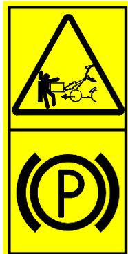
**Risque d'écrasement par un chargeur mobile - Engagez le frein de stationnement avant de quitter le siège du conducteur.**
